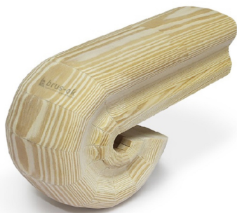
Окончание поручня Лиственница улитка АЕодн сращенное под 50 баляс. поручень 50*75 мм
